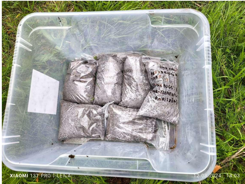
7.4. attēls. Sagatavotie augsnes paraugi ķīmiskajām analīzēm
