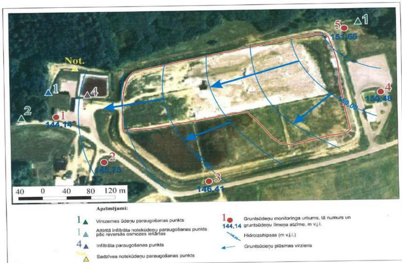
5.1. attēls Monitoringa tīklu shēma sadzīves atkritumu poligonā “Ciniši”
