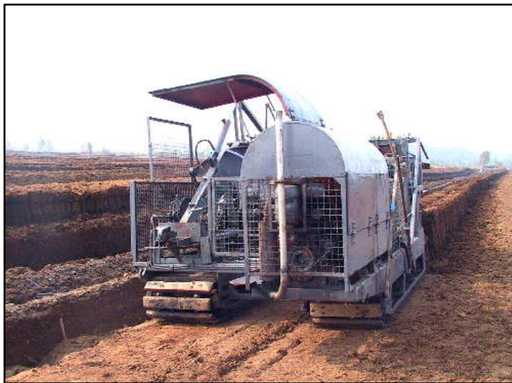
2.3.1.attēls. Grieztās kūdras bloku ieguve ar pašgājējmašīnu „Steba”
