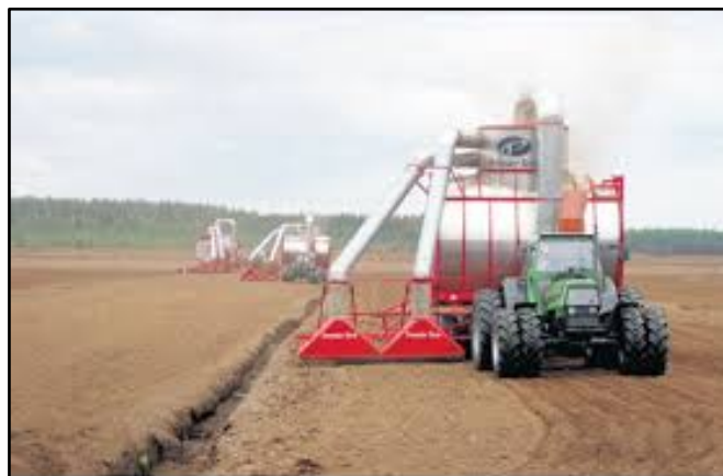
2.3.2.attēls. Frēzkūdras ieguve ar pneimatisko bunkurmašīnu
